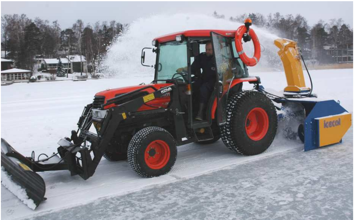
Kuva 4. Pienoistraktori Kubota ja jäähöylä Ice Cat
