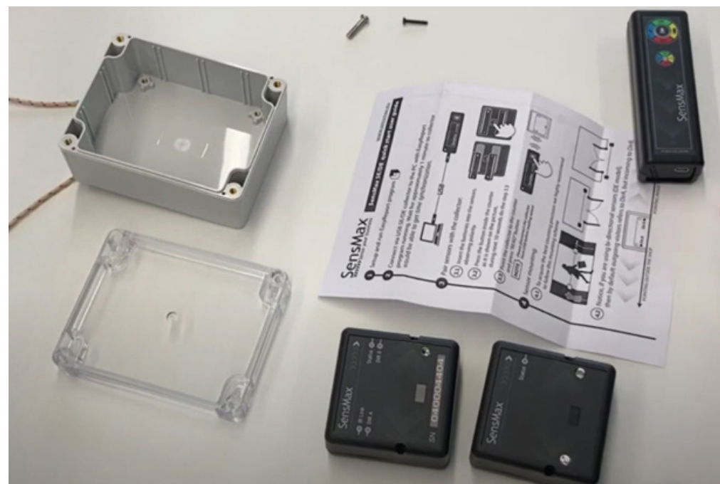
Kuvakaappaus ohjevideolta. Kuvassa näkyvät kaksi kävijälaskuria, datankeräysyksikkö, sekä laskureiden säännestävät suojakotelot.
